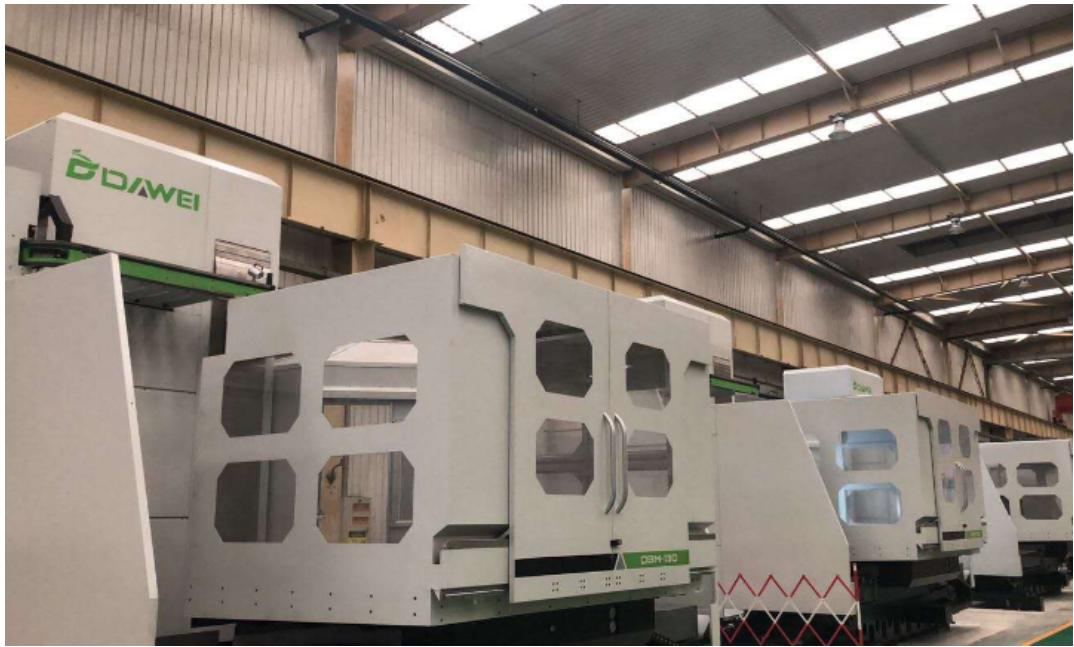
数控机床的操作和监控都是在数控单元中完成的，数控机床可以很好的解决复杂、精密、小批量和多品种的零件加工问题，是一种柔性的高效能的自动化机床，除此外还具备许多的特点，下面就由数控机床厂家来给大家讲述一下吧。1. 对加工对象的适应性强，适应模具等产品单件生产的特点，为模具的制造提供了合适的加工方法；2. 加工精度高，具有稳定的加工质量；3. 可进行多坐标的联动，能加工形状复杂的零件；4. 加工零件改变时，一般只需要更改数控程序，可节省生产准备时间；5. 机床本身的精度高、刚性大，可选择有利的加工用量，生产率高（一般为普通机床的3~5倍）；6. 机床自动化程度高，可以减轻劳动强度；7. 有利于生产管理的现代化。数控机床使用数字信息与标准代码处理、传递信息，使用了计算机控制方法，为计算机辅助设计、制造及管理一体化奠定了基础；8. 对操作人员的素质要求较高，对维修人员的技术要求更高；9. 可靠性高。数控机床易于操作，特别适用于复杂零件或对精度较高的大批量零件的加工，也是数控教学的好选择。轮廓控制数控机床销售
